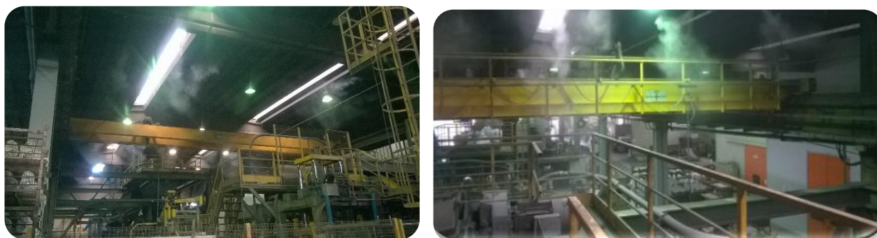
Figure 17. / 18. Utilizzo di sistemi di nebulizzazione di prodotti osmogenici in fonderia.
