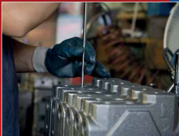
CONTROLLO A FIBRE OTTICHE
