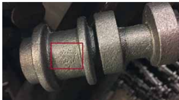
Fig. 1 - Dopo l'analisi, i difetti sono identificati come scorie e punte di spillo (vedere la regione della carcassa). Le riprese di colata (colate difettose) sono risultate associate a questi difetti.
