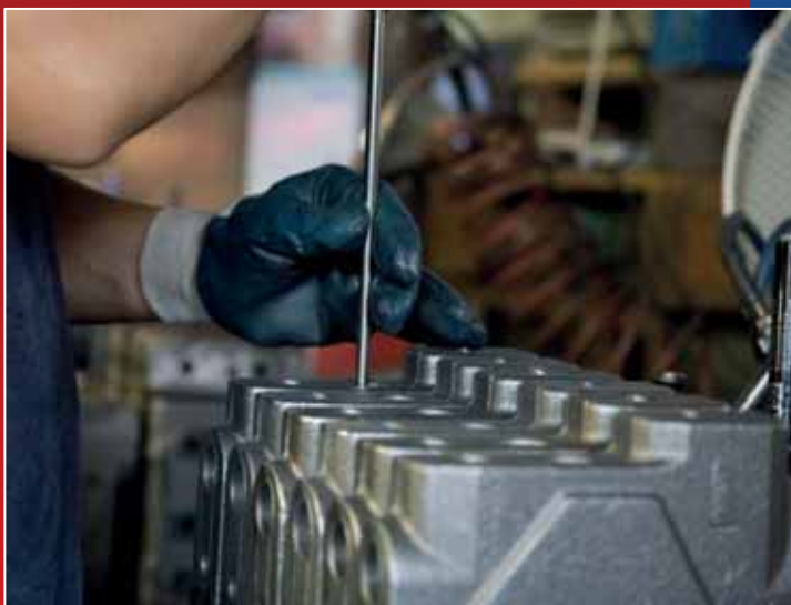
CONTROLLO A FIBRE OTTICHE
