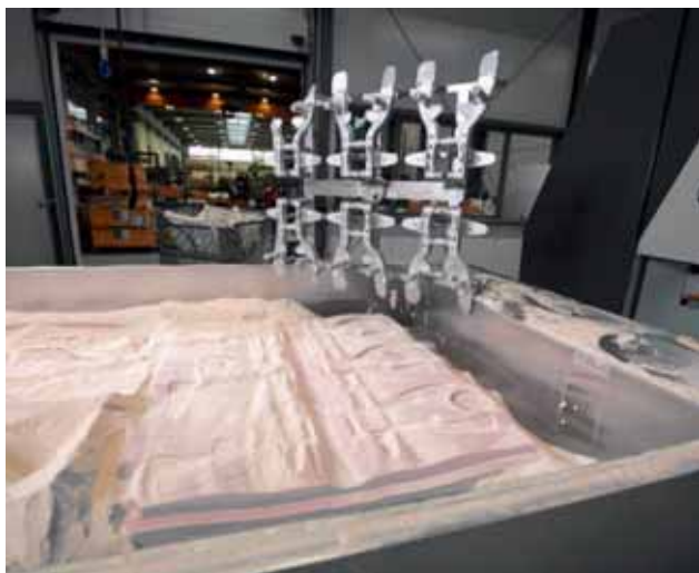
Fig 2 - Il lavoro di finitura con le anime NOVASET è molto inferiore rispetto a quello necessario con le anime in resina furanica. (Foto: Grunewald GmbH&Co.KG).
