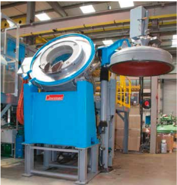
Fig. 1 - Forno VCAP 2,5 t.
