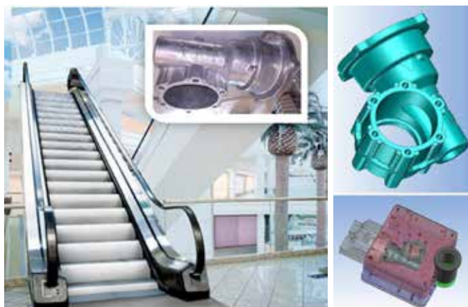
Fig. 1 – Prodotto di pressofusione: alloggiamento per motoriduttore. Fig. 1 – Diecasting product: housing for gearmotor.
