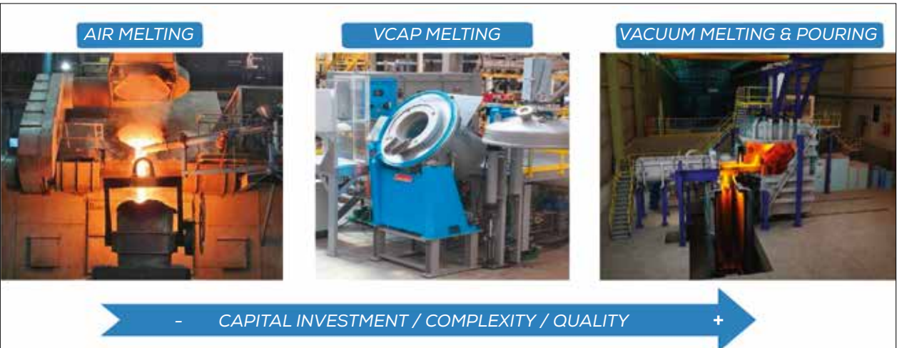
Fig. 2 - Schema della tecnologia VCAP come un connubio di fusione ad aria e fusione sottovuoto (VIM).
