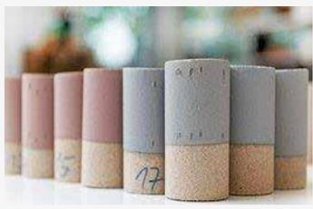
Fig. 9 - Intonaci refrattari HA per processo 3D printing.
