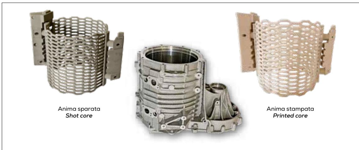
Fig. 1 - A sinistra l'anima di una camicia d'acqua di un alloggiamento di un motore elettrico sparata, a destra la stessa anima ma stampata. In ambedue i casi il legante è inorganico.
