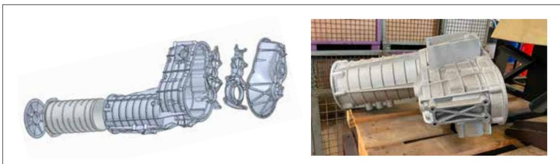
Fig. 11 - Nuovo sistema di trasmissione ibrida studiato, sviluppato e colato @COC. Comprensivo dello stampaggio dell'anima.
