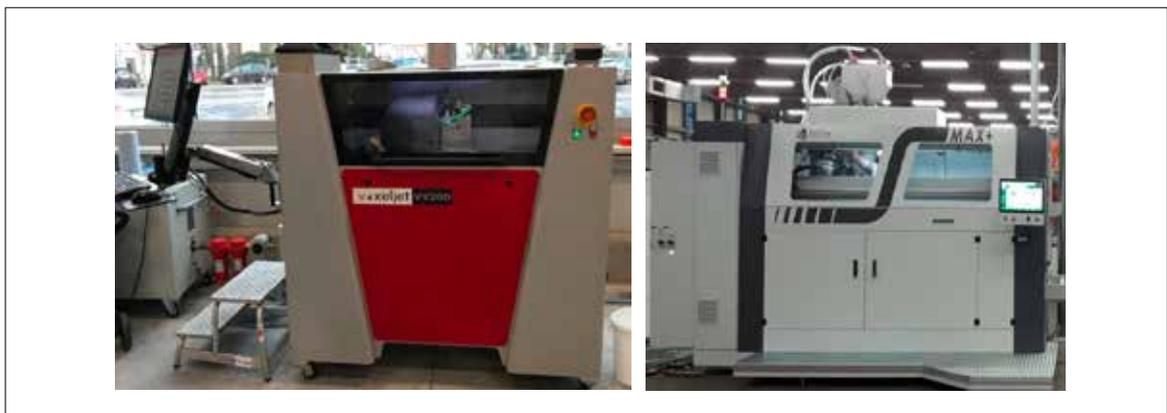
Fig. 6 - A sinistra la nostra stampante Voxjet VX 200 per progetti di ricerca e sviluppo. Dimensione Job Box 200x300x150mm. A destra invece ExOne S-Max+ per i progetti e i servizi ai clienti. Dimensione Job Box 1800x1000x600mm.
