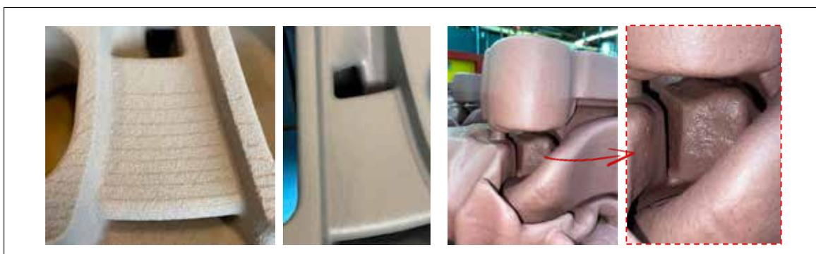
Fig. 10 - Esempi di copertura da Vernice Refrattaria su anime prodotte in 3D printing.
