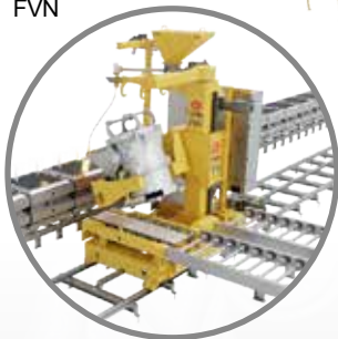
Macchina di colata FVN
