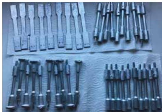
Fig. 5 - Prova di trazione in colata su campioni di Frech W80 rotondi da 9 mm e piatti da 3 mm.
