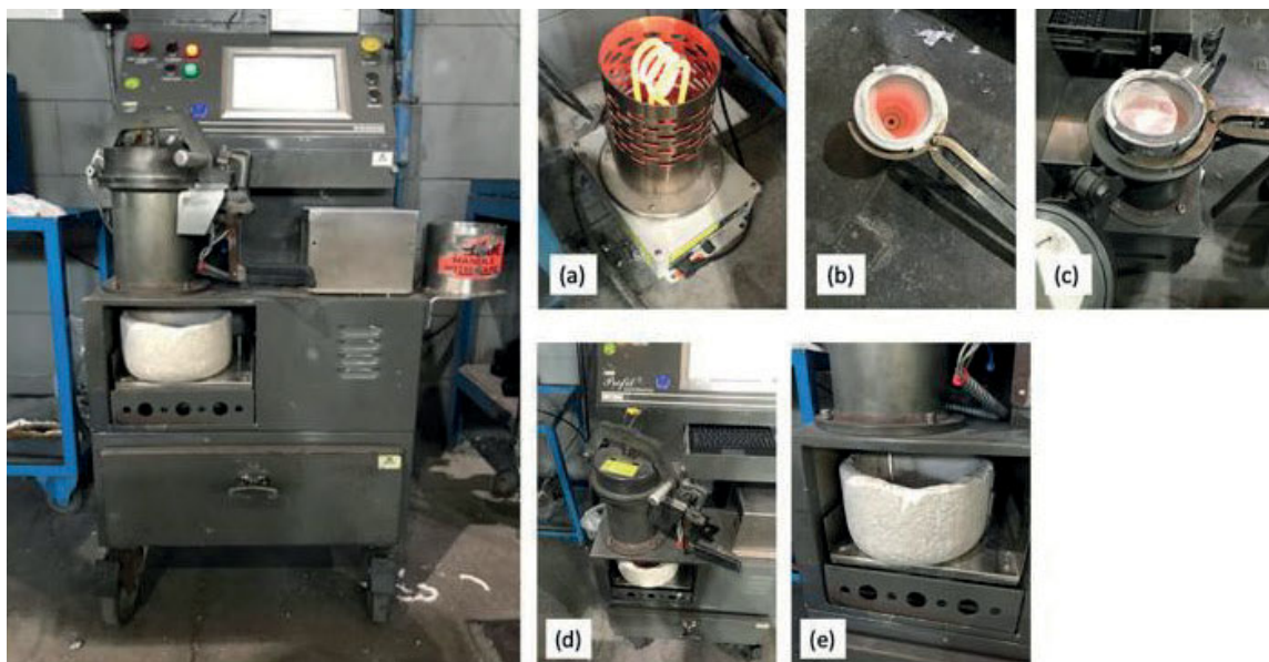
Fig. 1 – A sinistra lo strumento noleggiato da Ghial per questo studio. A destra: (a) scaldia crogiolo, (b) crogiolo preriscaldato con il filtro ceramico installato sul fondo, (c) posizionamento del crogiolo pieno di lega all'interno della camera, (d) chiusura della camera e avvio della prova, (e) lega filtrata durante il test [2].
