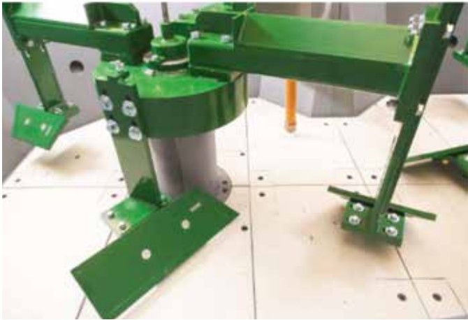
Una prospettiva interna del Multi-Cooler per raffreddamento terra. An internal perspective of the Multi-Cooler for sand cooling.
