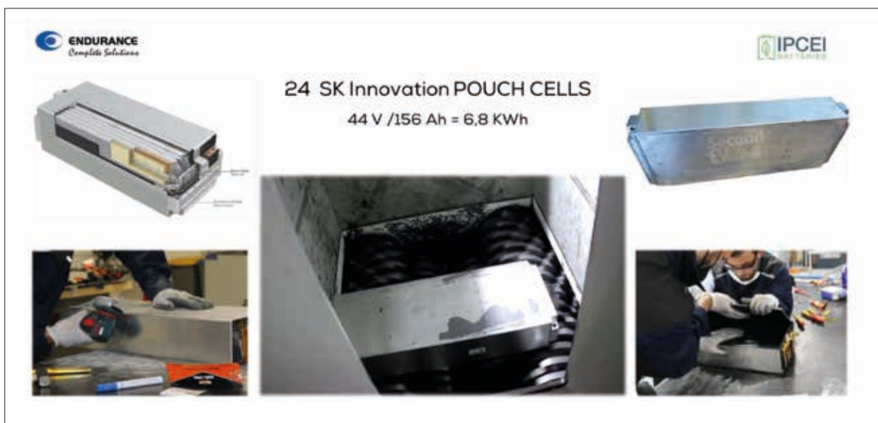
Fig. 3 - Tecniche di dis-assemblaggio modulo con celle Ioni-Litio in formato pouch. Fig. 3 - Module disassembly techniques with pouch-format lithium-ion cells.
