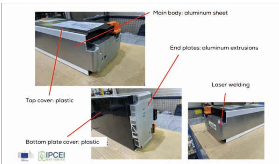
Fig. 2 - Modulo ottenuto a mezzo saldatura laser di lamiere ed estrusi, chiusure in plastica. Fig. 2 - Module obtained by laser welding of sheet metal and extrusions, plastic closures.
