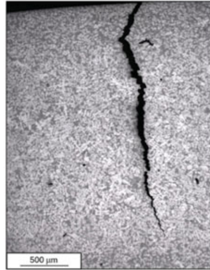
Fig. 13 - Microstruttura della cricca dopo la prova di piegatura di campioni HPDC AlSi10MnMg dopo trattamento di invecchiamento a 170 °C per 3 h osservata mediante microscopio ottico.
