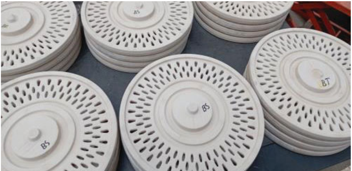
Fig. 4 - Anime in Cordis per fusioni in ghisa
