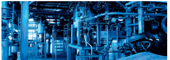
Fabbricazione prodotti ausiliari. L'impianto comprende 8 miscelatori dedicati alla produzione della componente isocianica delle resine per il sistema "Cold Box" e "No Bake" uretanico, degli induritori "Hot Box" e "Thermoshock", dei prodotti ausiliari per fonderia. Capacità totale installata: 100.000 litri.
