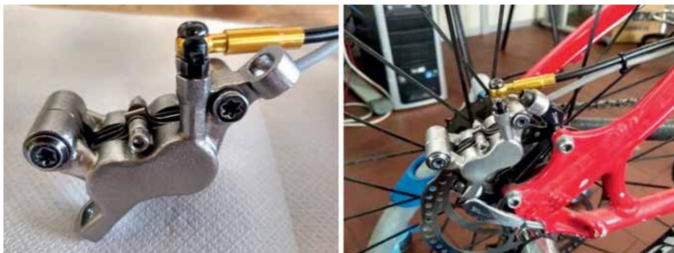
Fig. 5 - Pinza freno sensorizzata: prototipo del componente completo e assemblato (a sinistra) e integrato nell'impianto frenante a bordo di una mountain-bike da competizione (a destra).
