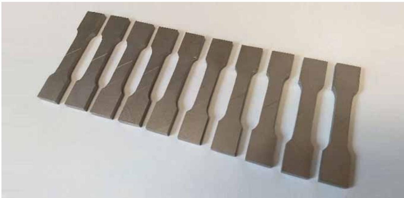
Fig. 1 - Esempio di provini di trazione in acciaio 17-4 PH con sospensione del processo di crescita e orientazione a 45°.
