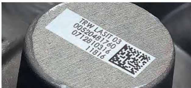
Marchatura laser di un codice bidimensionale e di un testo per la tracciabilità del componente.
