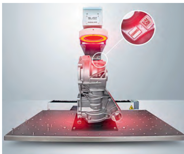
Marcatura laser di un componente fuso con laser a Fibra e sistema di visione per la verifica del codice.
