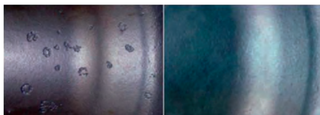
Fig. 1 - Superficie grezza di fusione a contatto con terra di formatura preparata con residui di maniche ricche di fluoro (sx); superficie grezza di fusione a contatto con terra di formatura preparata con residui di maniche esenti fluoro (dx). Adattamento da [7].
