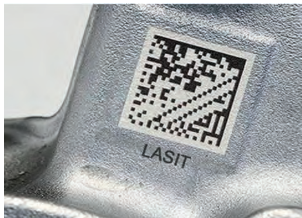
Marcatore Laser di un codice bidimensionale su un componente metallico fuso.
