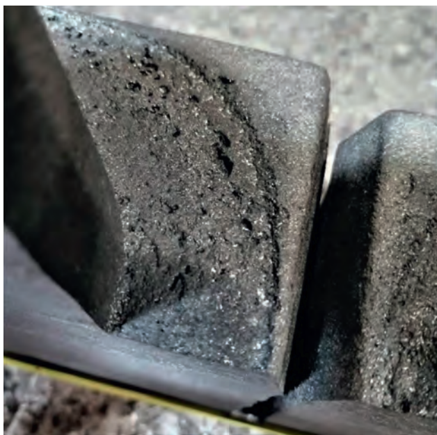
Fig. 5 - Dettaglio del cubo colato con manica KX. All'interno della superficie butterata si evidenziano i depositi bianchi tipici del fish-eye defect.
