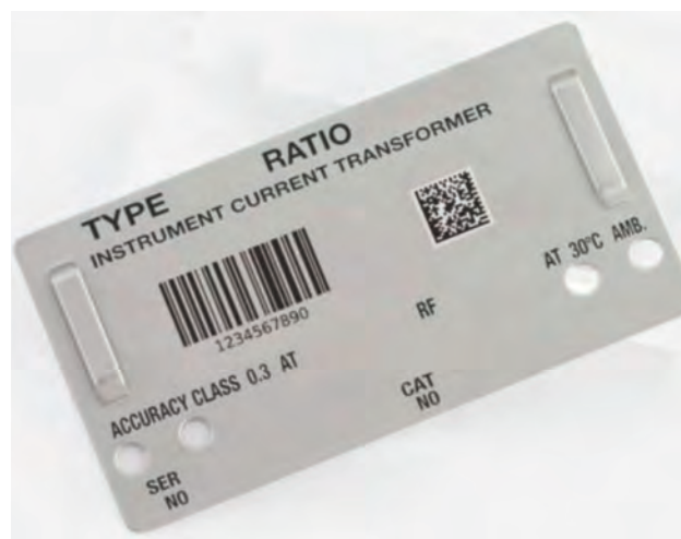
Marchatura laser di una targhetta metallica: testo, codice monodimensionale e codice 2D.
