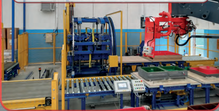
“MOULDING LOOP” Impianto di formatura e rigenerazione termica totale della sabbia ELICHE RADICE ITALIA
