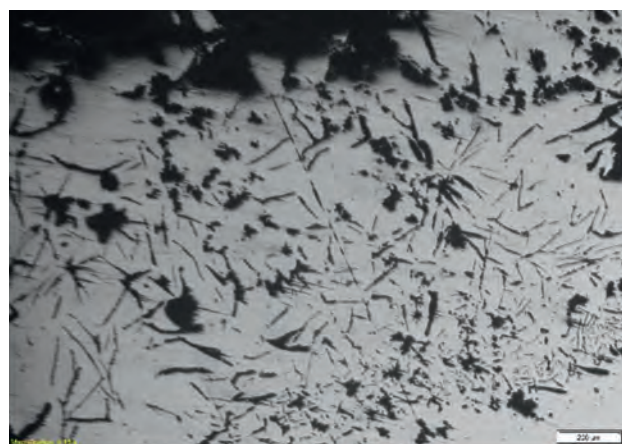
Fig. 7 - Micrografia della zona sub-superficiale del cubo colato con minimanica FX (troncoconica 7/10 produttore 1). Alla zona di interfaccia si nota lo strato di pelle lamellare (50x ingrandimenti).
