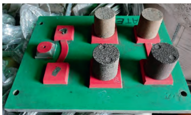
Fig. 2 - Placca modello progettata in HA ITALIA e realizzata per il progetto.
