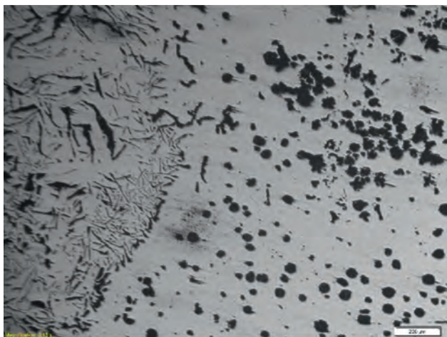
Fig. 8 - Micrografia del cubo colato con minimanica FX (troncoconica 7/10 produttore 1). Superata l'interfaccia metallo/forma la degenerazione prosegue fino ad una zona di transizione tra lamellare e noduli degenerati (50x ingrandimenti).
