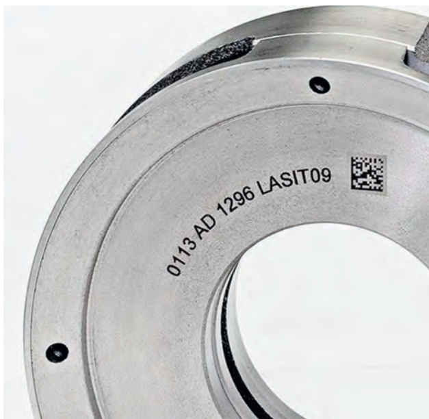
Componente fuso marcato a laser per garantirne la tracciabilità. Laser-marked cast parts for guaranteeing traceability.
