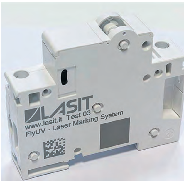
Marcatore laser di un componente plastico con la tecnologia ultravioletta.
