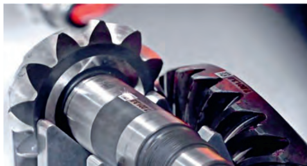
Marcatura laser di coppie coniche con Laser a Fibra infrarosso. Laser marking of bevel gears with infrared fibre laser.
