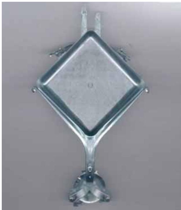
Fig. 4 - Scatola con pareti sottili da 80 x 80 x 20 mm, spessore delle pareti 0,3 mm, con sistema di alimentatore classico.
