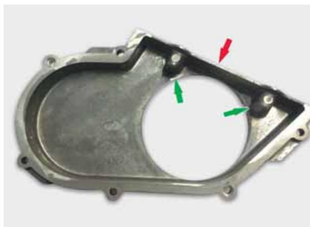
Fig. 2 - Parte del coperchio dell'albero con visibili la flangia e le borchie per il montaggio. La freccia rossa indica la flangia, le frecce verdi indicano invece le borchie all'interno delle quali sono ricavati i fori filettati per il montaggio.
