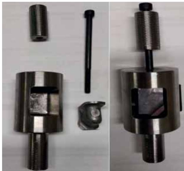
Fig. 7 - Afferraggio e configurazione di montaggio per sollecitare a trazione la borchia.
