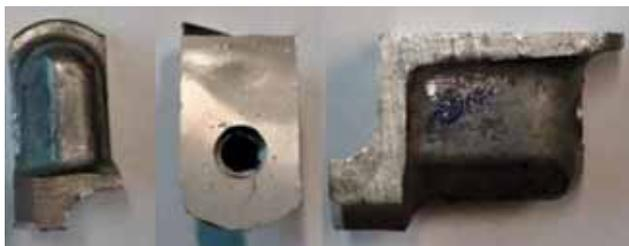
Fig. 3 - Tre diverse viste di una borchia asportata mediante taglio. Nella vista centrale è in evidenza il foro filettato.
