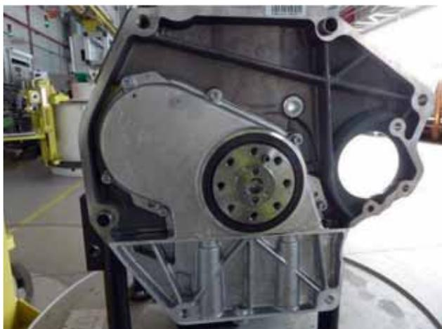
Fig. 1 - Coperchio di albero motore automobilistico montato.
