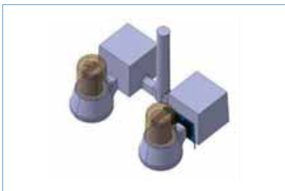
Fig. 4 - NetFrame collocata nel collo della materozza "FREDDA". Fig. 4 - NetFrame placed in "COLD" riser neck.
