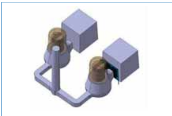
Fig. 3 - NetFrame collocata nel collo della materozza "CALDA". Fig. 3 - NetFrame placed in "HOT" riser neck.
