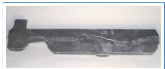
Fig. 9 - Filtri sovraccarichi e rotti in una batteria di filtri. Fig. 9 - Overloaded and broken filters in a filter battery.
