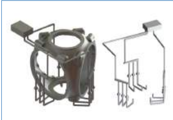
Fig. 16 - Sistema di colata vecchio stile per hub turbina eolica. Fig. 16 - Old style gating system at wind turbine hub.
