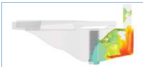
Fig. 3 - Flusso simulato davanti a un filtro. Fig. 3 - Simulated flow in front of a filter.
