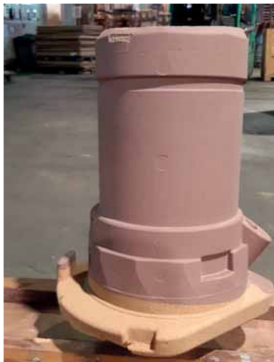
Fig. 17 - Applicazione ad immersione su anima in cold box. Fig. 17 - Immersion application on cold box core.
