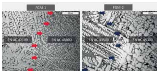
Fig. 3 - Giunzione tra le leghe negli FGM realizzati. Le interfacce sono evidenziate con delle frecce. Ingrandimento 10X.
