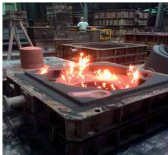
Fig. 1 - Asciugatura di una staffa tramite accensione, subito dopo la verniciatura con intonaco all'alcol.
