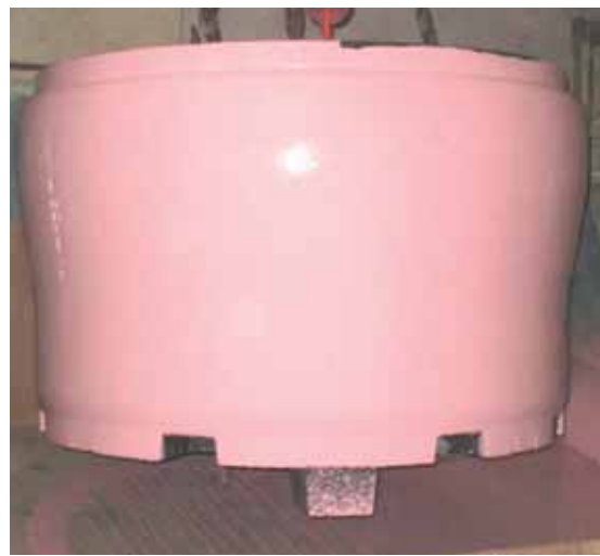
Fig. 16 - Applicazione a lavaggio su anima in furanica. Fig. 16 - Wash application on furan core.
