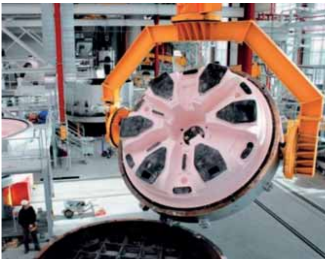
Fig. 15 - Applicazione a pennello su staffa furanica. Fig. 15 - Brush application on furan mould box.
