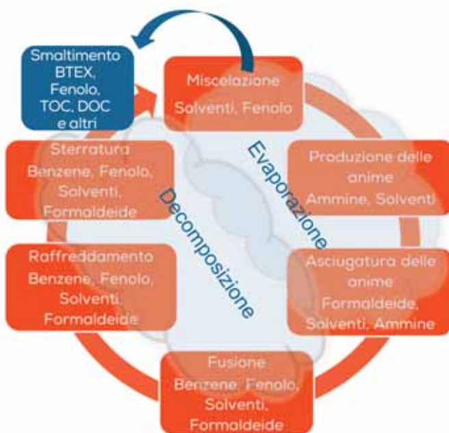
Fig. 1 - Fonti di emissione in Fonderia – Processo Cold-Box. Fig. 1 - Foundry emission sources – Cold-Box Process.
