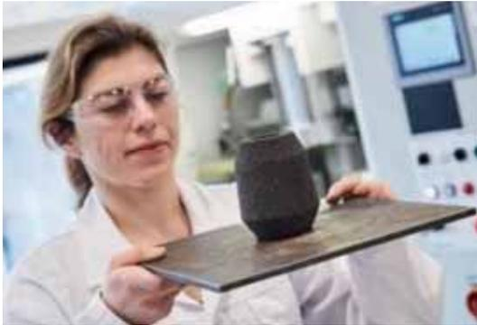
FEEDEX FEF - un nuovo materiale per manicotti di alimentazione ad alta resistenza, privo di emissioni di fluoro e altamente esotermico.
