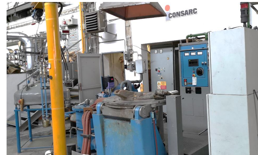
VCAP forno Consarc VCAP da 80 kg
