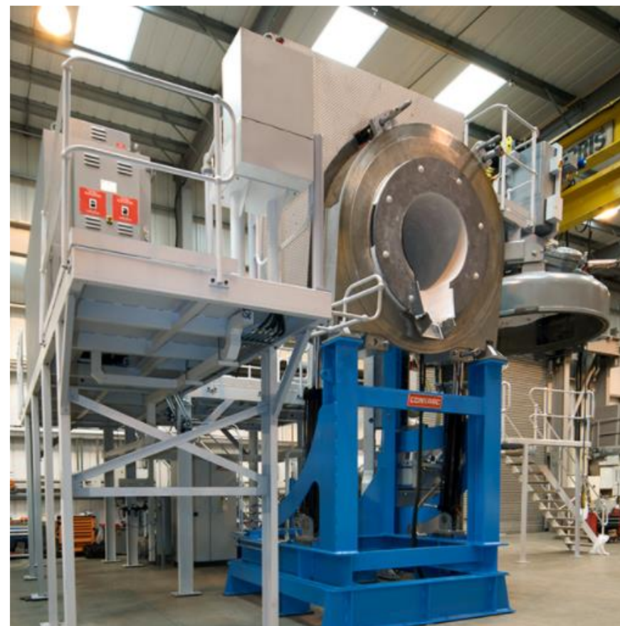
Forno VCAP Consarc di 1,500kg
