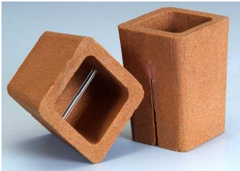
Crogiolo utilizzato per l'analisi termica
