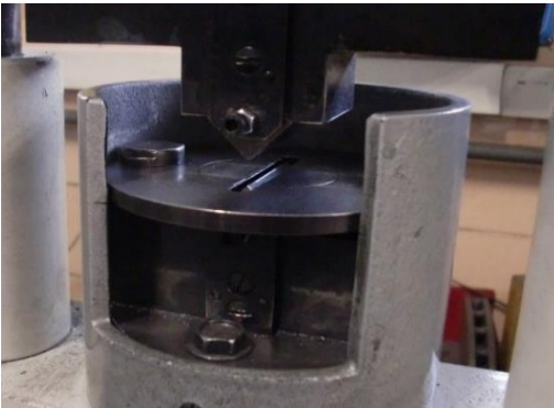
Dettaglio della macchina di prova di compressione del cuneo
