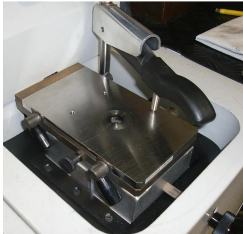
Dettaglio del quantometro, utilizzato per l'analisi chimica
