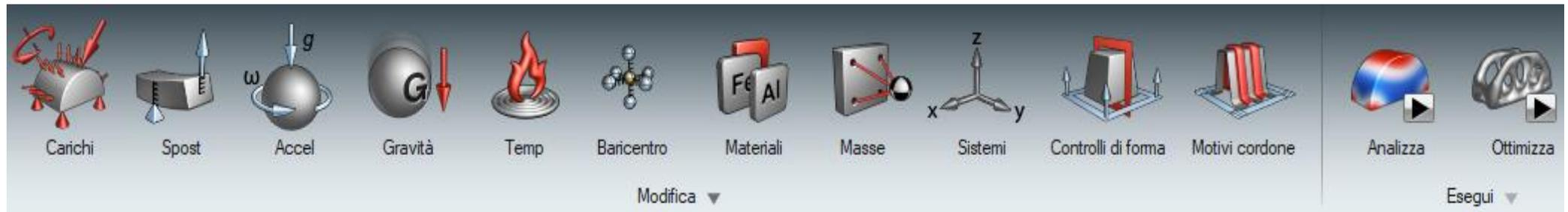
Il modulo *Inspire* più utilizzato è *Struttura*, che contiene la maggior parte delle funzioni necessarie ad impostare i vincoli per l'analisi strutturale FEM e per l'analisi di ottimizzazione topologica.
