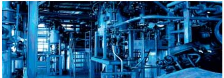
**Fabbricazione prodotti ausiliari.** L'impianto comprende 8 miscelatori dedicati alla produzione della componente isocianica delle resine per il sistema "Cold Box" e "No Bake" uretanico, degli indurenti "Hot Box" e "Thermoshock", dei prodotti ausiliari per fonderia. Capacità totale installata: 100.000 litri.
