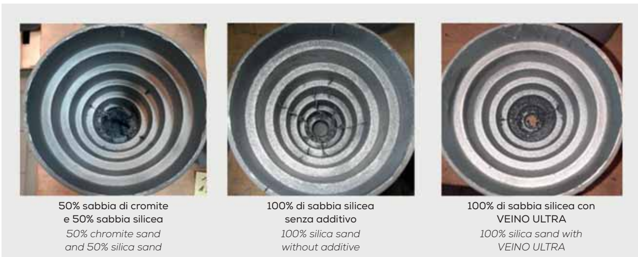
Fig. 6 - Cono a gradini larghi, Ghisa Lamellare. - Temperatura di colata 1410-1420 °C. intonaco a base d'acqua, circa 300 µm di spessore dello strato.
