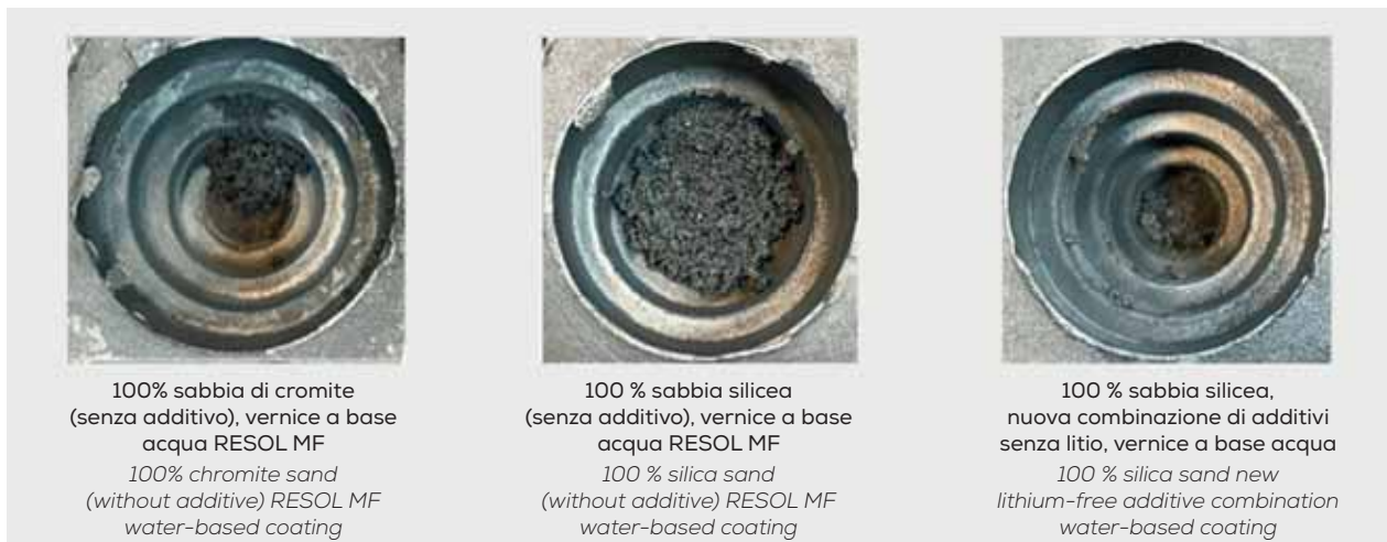
Fig. 8 - Coni a gradini piccoli, Ghisa Lamellare, temperatura di colata circa 1420 °C, intonaco a base di acqua.
