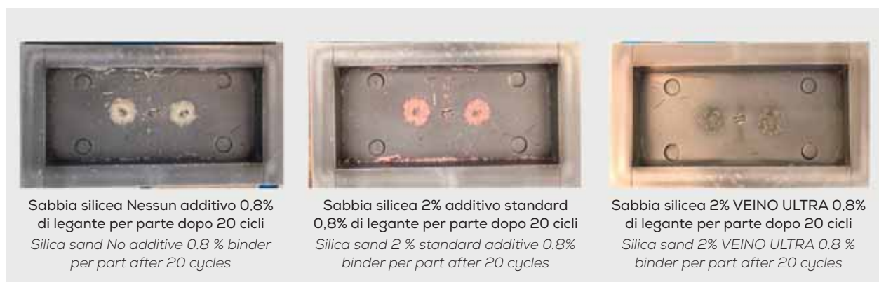
Fig. 3 - Cassa anima; rapporto tra additivo per sabbie e accumulo di pece da legante (cold box) al di sotto delle boccole di sparo. Risultato dopo 20 cicli e senza applicazione del distaccante (test di laboratorio).
