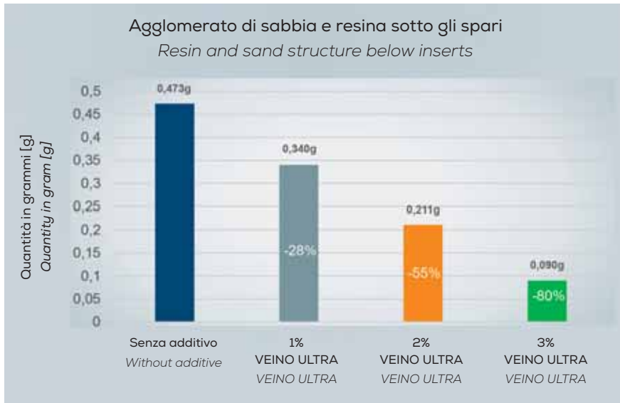
Fig. 4 - Riduzione dell'accumulo di pece sotto le boccole di sparo in funzione della quantità di additivo, dopo 20 cicli e senza applicazione di distaccante (test di laboratorio).
