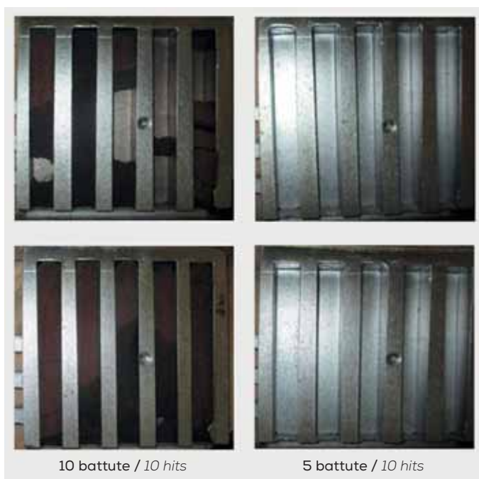
Fig 9 - Campione di prova per la valutazione della sterrabilità. Materiale: alluminio, temperatura di colata: 650 °C, 1 battuta = martello pneumatico a 2 bar; t = 3 secondi.
