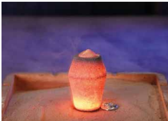
Fig. 4 - Burn-off costante dell'alimentatore FEEDEX NF1.
