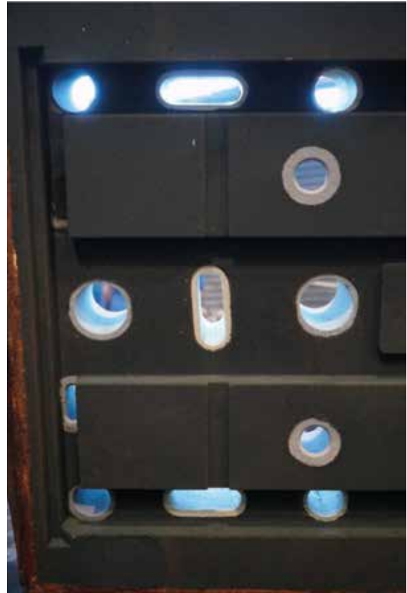
Fig. 2 - Maniche esotermiche ed isolanti posizionate nella forma. Fig. 2 - Exothermic and insulating sleeves positioned in the mould.
