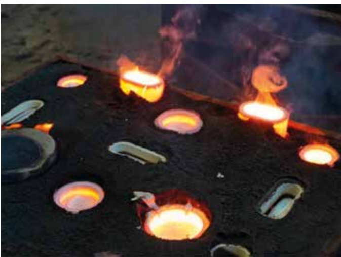
Fig. 3 - Reazione esotermica chiaramente visibile delle maniche FEEDEX NF1. Fig. 3 - Clearly visible exothermic reaction of FEEDEX NF1 sleeves.
