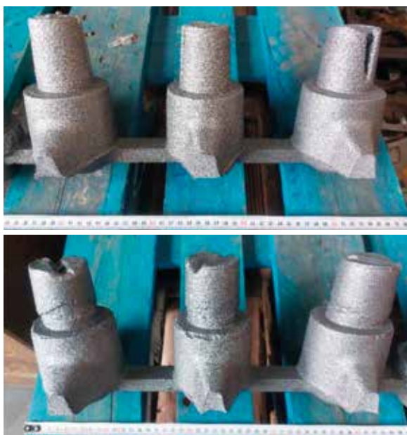
Fig. 8 - Dettaglio degli alimentatori dopo granigliatura. In alto, i residui della classica manica 6/9. In basso, i residui della manica CHEMEX EK 50/80 T.
