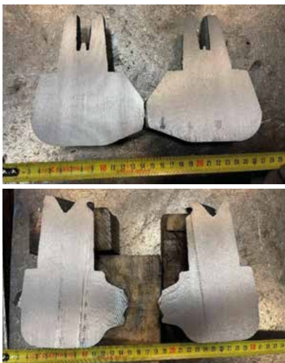
Fig. 9 - Residuo degli alimentatori sezionati. In alto, il residuo della manica CHEMEX EK 60/90 T. In basso, il residuo della classica manica 7/10.
