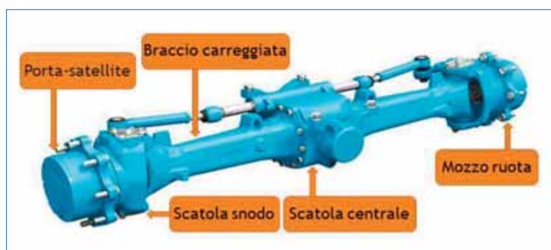
■ Fig. 4 - Assale per macchina agricola analizzato.
