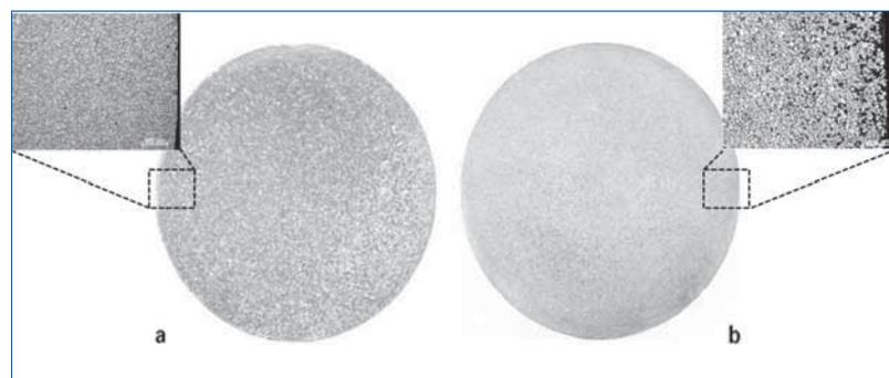
■ Fig. 8 - Macro- e microstrutture di billette ( $\varnothing 80$  mm) in AZ31 prodotte tramite (a) processo convenzionale e (b) DCRC [13].
