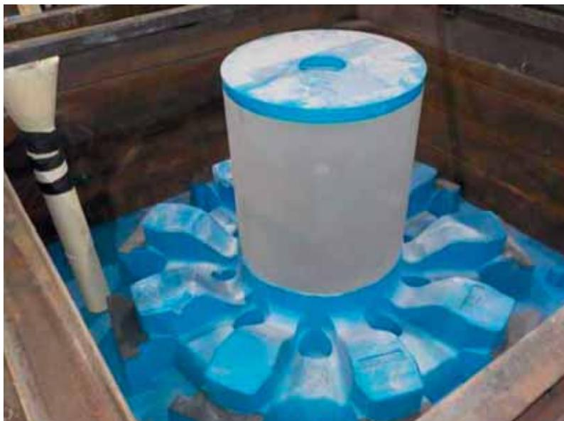
■ Il tappo manica, sviluppato da ASK Chemicals per il progetto, combina sia caratteristiche isolanti che esotermiche. In particolare la dimensione e la conformazione del getto hanno richiesto una soluzione di alimentazione su misura.
