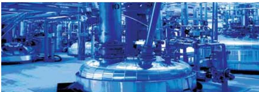
**Produzione resine.** L'impianto di produzione resine della Cavenaghi include 4 reattori completamente computerizzati e 5 parzialmente computerizzati, per una capacità totale installata di 90.000 litri.
