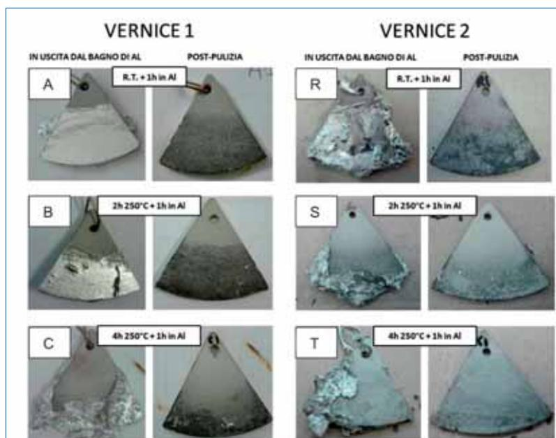
■ Fig. 4 - Campioni post immersione in bagno di alluminio fuso con e senza i residui di alluminio.
