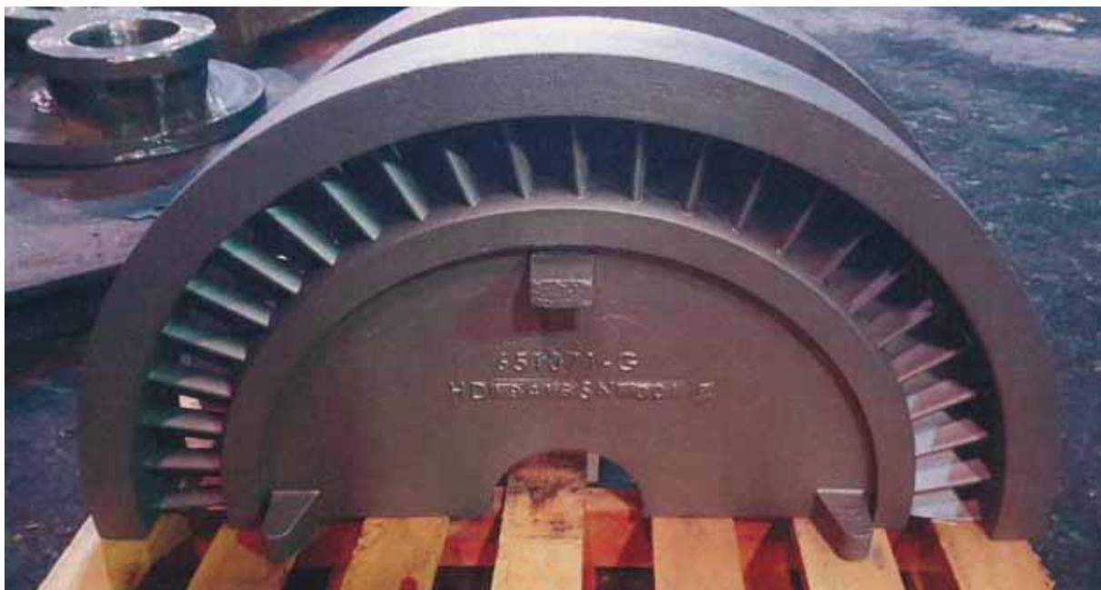
■ Ogni colata è metà della rotazione completa. Le prime pale di ogni metà devono essere trattate per sposarsi una volta assemblate, quindi è necessaria una buona stabilità dimensionale.
