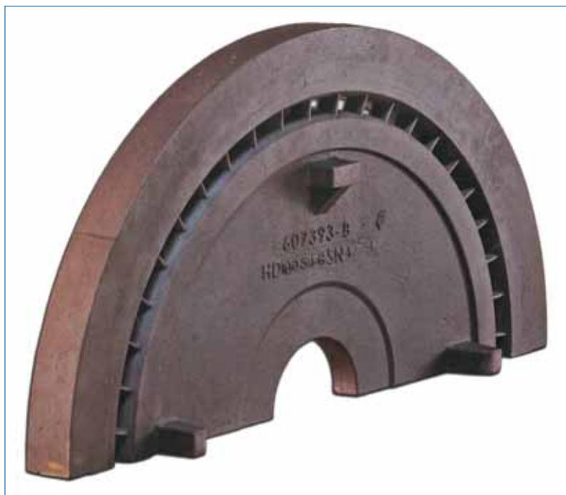
■ Il getto del diaframma in ghisa da 300 libbre passa in una turbina a vapore per aiutare e guidare l'afflusso di vapore.
