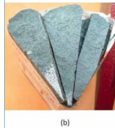
■ Fig 3 - (a) Inoculazione vuol dire disossidazione (b) in successione i provini di tempera dal forno, dopo preconditionamento e dopo trattamento e post inoculazione.
