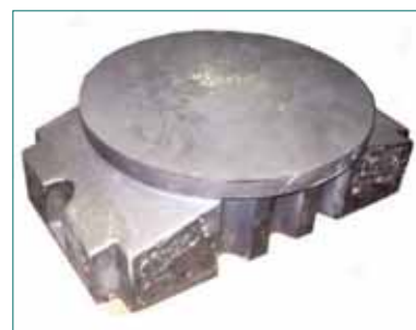
■ Fig. 9 - Tavola rotante (per cortesia Fonderia di Kolbus, Rahden - DE) [1].
