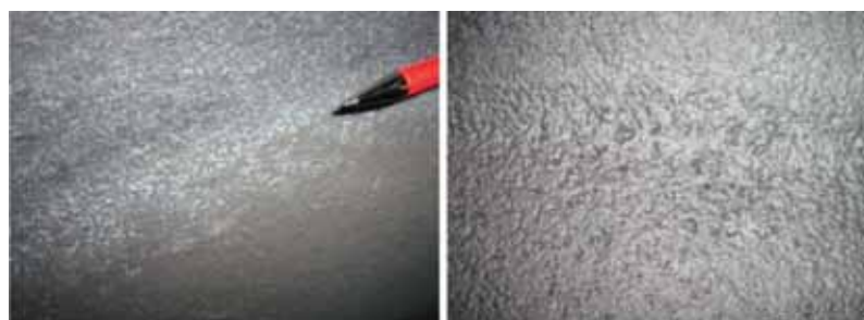
■ Fig. 2 - Superficie dopo sterratura (sinistra) e dopo granigliatura (destra) [2].
