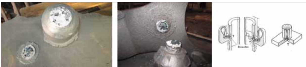
■ Fig.21 - Esempi di difetti di risucchio a causa di un errato posizionamento delle alimentazioni.
