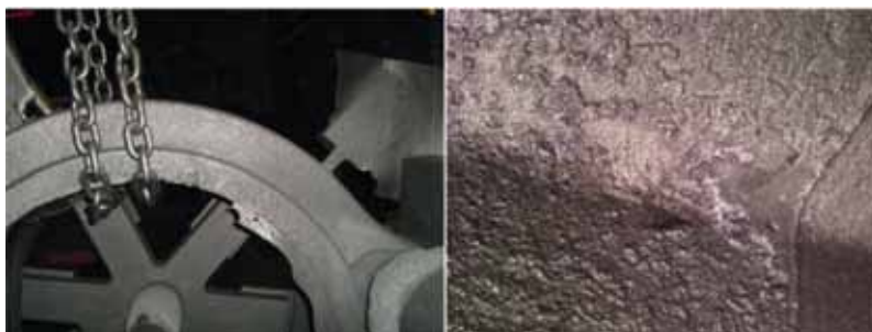
■ Fig. 3 - Superficie di un getto butterato riconducibile al difetto denominato white film [2].
