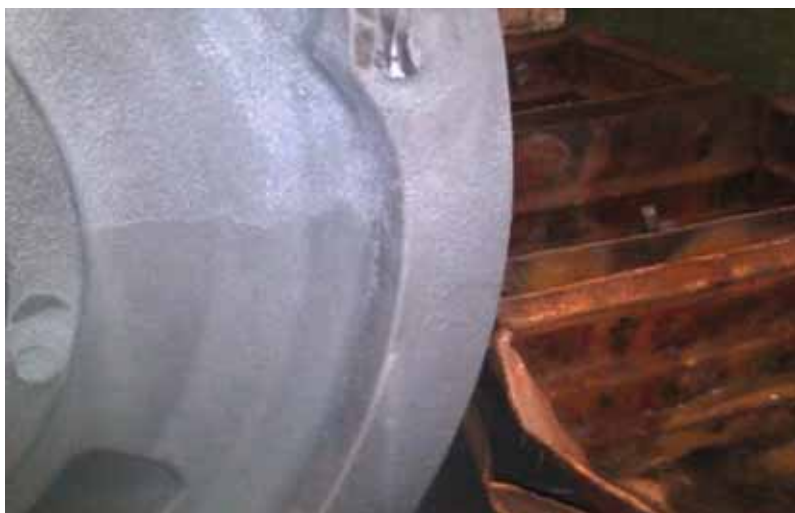
■ Fig. 15 - Zona di demarcazione di un getto impianto eolico [1-2].
