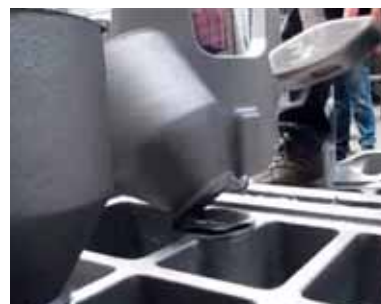
■ Fig. 5 - NETCore ® - Manica da 85kg, collo 100mm.
