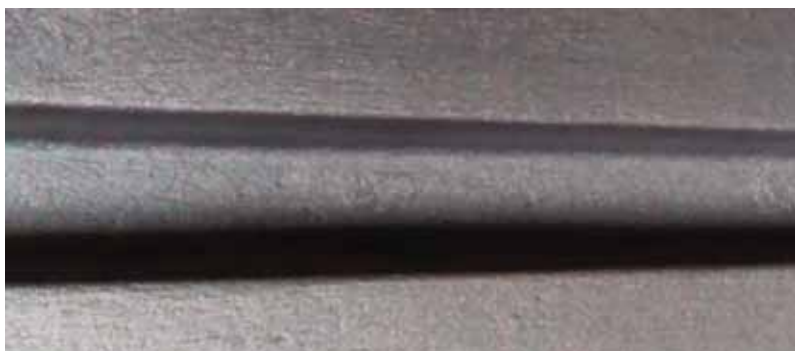
■ Fig. 17 - Superficie dello stesso grezzo di Fig. 16 dopo l'applicazione dell'impregnate Duro-sol® 9125 W20.
