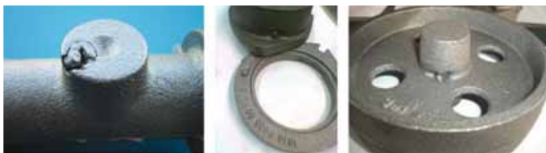
Fig. 8 - Getti in gg che presentano dei difetti di ritiro anomali.
