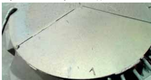
■ Fig. 12 - Risultato fusorio del primo settore, l'unico con l'applicazione del Durosol® 9125 W20 (cfr. Tab. 2) [1-2].
