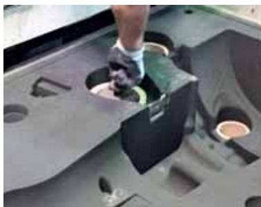
■ Fig. 12 - Il posizionamento di NETFrame® dopo formatura.
