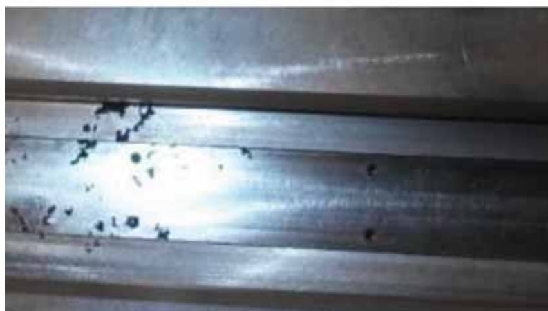
■ Fig. 16 - Superficie del grezzo realizzato in una fonderia italiana: grezzo dopo granigliatura (in alto) e dopo lavorazione meccanica (in basso).
