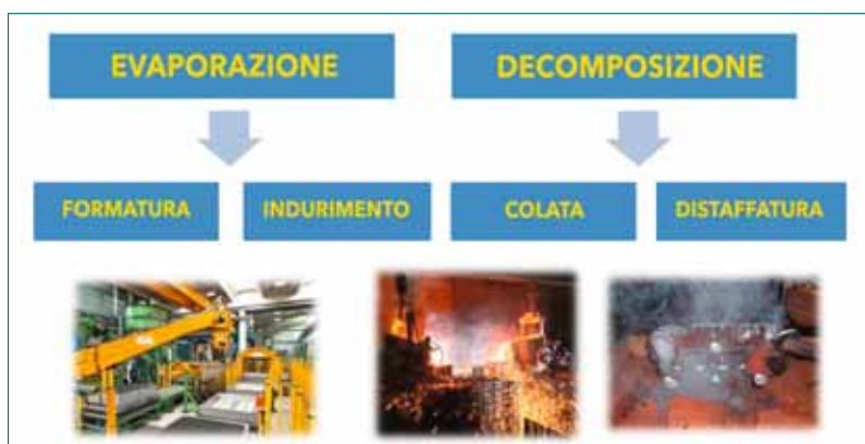
Fig. 7 - Processi di emissione dei VOC in fonderia.
