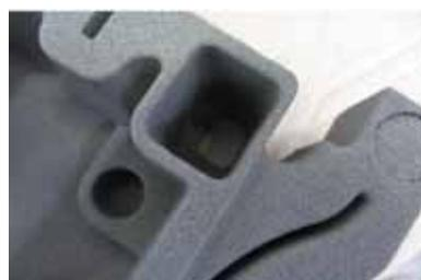
Fig. 7 - Particolare di anima realizzata con sistema GEOTEC.
