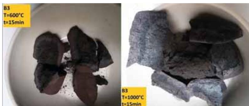
■ Fig. 3 - Risultato delle prove in forno sulla bricchetta B3.
