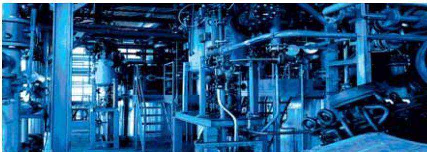
**Fabbricazione prodotti ausiliari.** L'impianto comprende 8 reattori dedicati alla produzione della componente isocianica delle resine per il sistema "Cold Box" e "No Bake" uretanico, degli induritori "Hot Box" e "Thermoshock", dei prodotti ausiliari per fonderia ed dei sali di sodio e potassio per l'industria della detergenza. Capacità totale installata: 100.000 litri.
