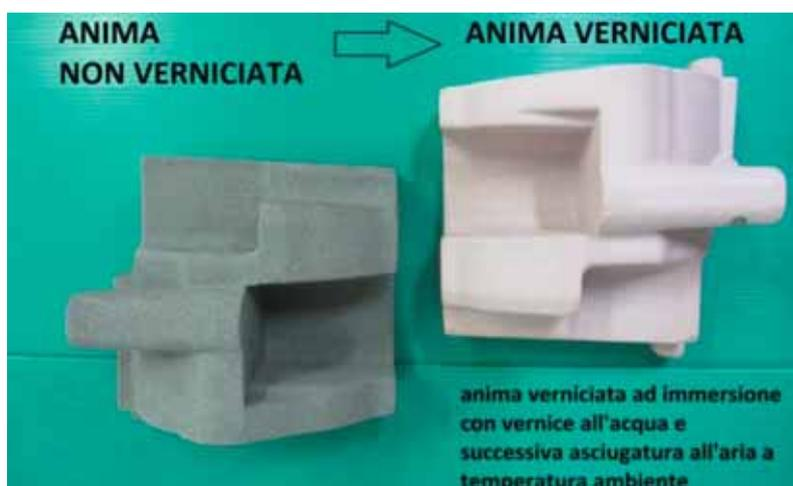
Fig. 8 - Verniciatura ad acqua su anima in GEOTEC.
