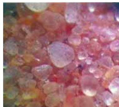
■ Fig. 7 - Questo campione è stato recuperato nell'impianto rotativo a microonde dalla condizione della prova 1, come mostrato in Fig. 3. l'indice di LOI era 0,01. le aree più scure sono Magnesite.
