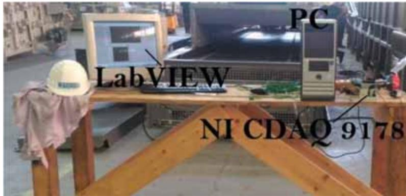
Fig. 10 - Stazione di acquisizione dati.
