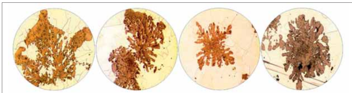
■ Fig. 9 - Forma della grafite: Grafite non sferoidale, influenza fortemente negativa sui valori di resilienza.
