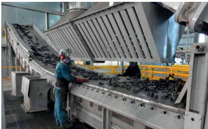
■ MCC®: raffreddatore getti con fondo linea per cernita e smaterozzatura.
