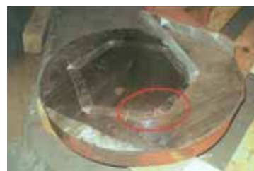
Fig. 15 - Pezzo d'angolo mancante (sezione di un carosello di filtri).
