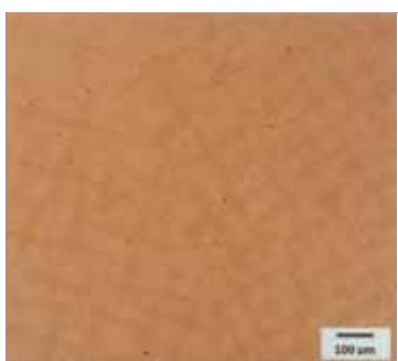
Fig. 3 - Micrografia ottica dell'acciaio C dopo trattamento di solubilizzazione simile a quella degli acciai A e B, completamente austenitica.
