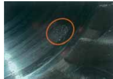
Fig. 12 - Pezzi di filtro inclusi in un getto e riportati alla luce dopo lavorazione di macchina.
