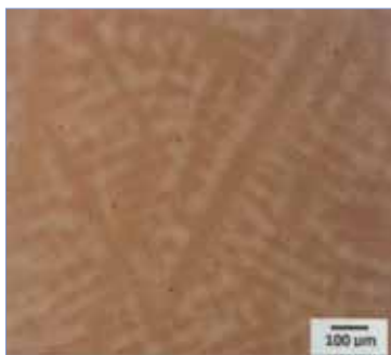
Fig. 1 - La micrografia ottica dell'acciaio A dopo trattamento di solubilizzazione mostra una struttura austenitica quasi al 100%. I campioni sono stati attaccati con Nital 10% seguito da reagente di Klemm.
