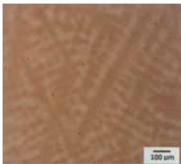
Fig. 2 - Micrografia ottica dell'acciaio B dopo trattamento di solubilizzazione mostra una struttura dendritica di Austenite..
