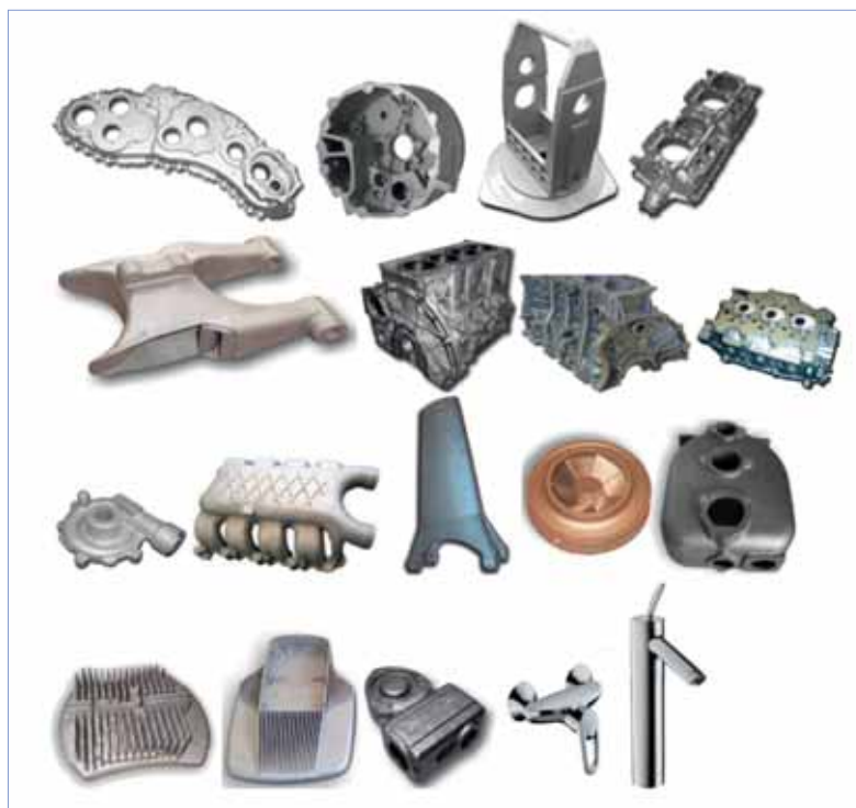
Fig. 8 - Esempi di pezzi fusi realizzati con il processo 3DP ExOne.
