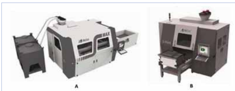
Fig. 1 - A. Sistema S-Max con job box per prodotti stampabili da 1800x1000x700 mm. B. Sistema S-Print con job box per prodotti stampabili da 800x500x400 mm.
