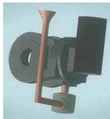
Fig. 28 - Esempio di alloggiamento con filtro per implementazione nel software di simulazione.
