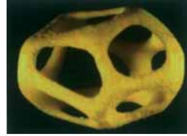
Fig. 2 - Tipica cellula dodecaedrica di un filtro.
