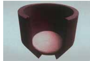
Fig. 10 - Materozza a collo in giù con filtro grande.
