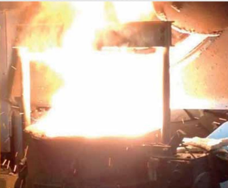
*Trattamento convenzionale con lega al Mg. Copertura con rottame di acciaio*
