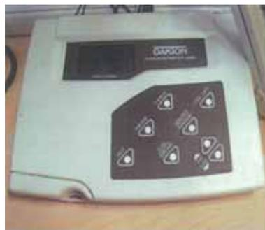
■ Fig. 5 - Misuratore della conducibilità elettrica.
