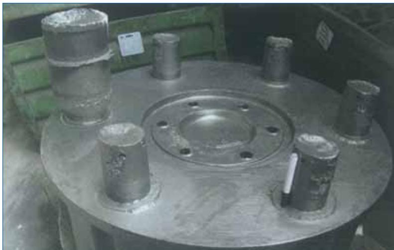
Fig. 11 - Getto di acciaio al manganese: confronto tra il comportamento della manica tradizionale (estrema sinistra) e quello della mini-manica (al centro e a destra).
