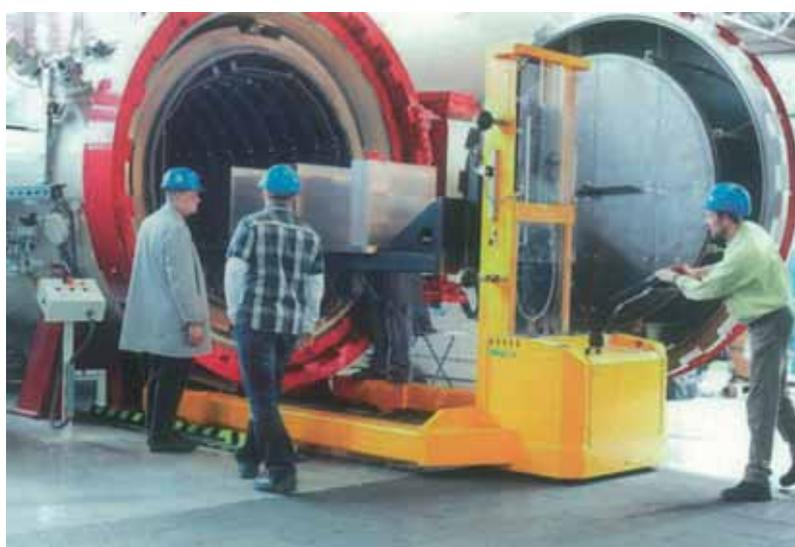
■ Fig. 4 - Un forno moderno per trattamenti termici in vuoto alla Kind % Co. per stampi per presso colata pesanti fino a 6000 kg.
