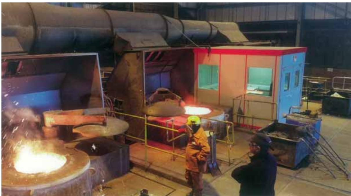
■ Una fonderia in Gran Bretagna modernizzata nel reparto di fusione: in tempi record il manteneriore VIP (inductotherm con tecnologia inverter) è stato rimosso e il VIP esistente da 2500 kW è stato riposizionato ed installato per far funzionare una fornace da 4 tonnellate. Infine un nuovo impianto da 3500 kW Dual Trak è stata installata.
