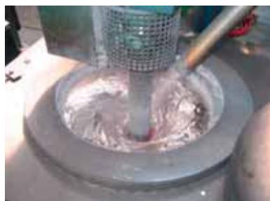
■ Fig. 3 - Formazione del vortice e dosaggio del flusso.
