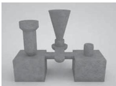
■ Fig.19 - Volume ridotto dell'alimentatore.
