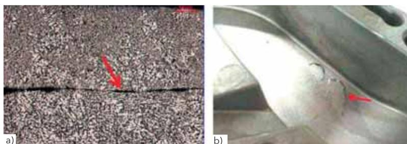
Fig. 2 - a) Micrografia di un giunto freddo, b) Esempio di laminazione su componente [25].
