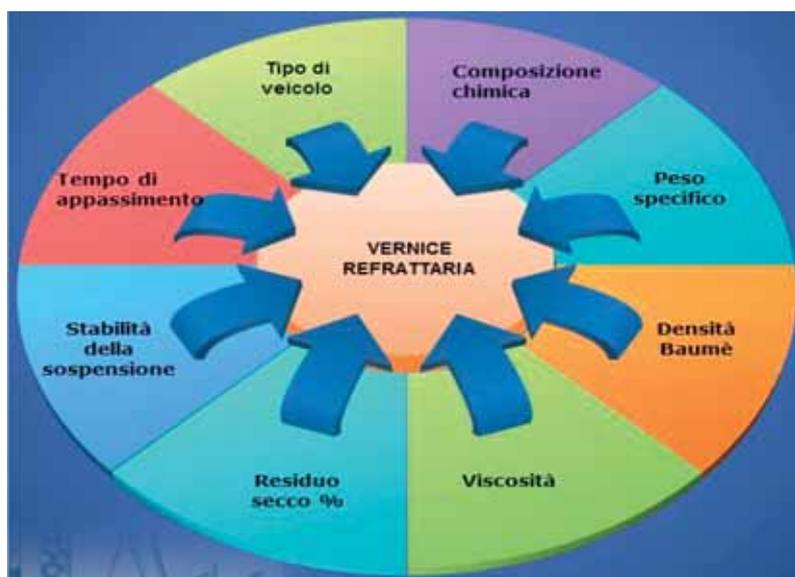
Fig. 5 - Proprietà della vernice refrattaria.
