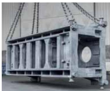
■ Fig. 1 - Getto realizzato mediante processo Full Mold.
