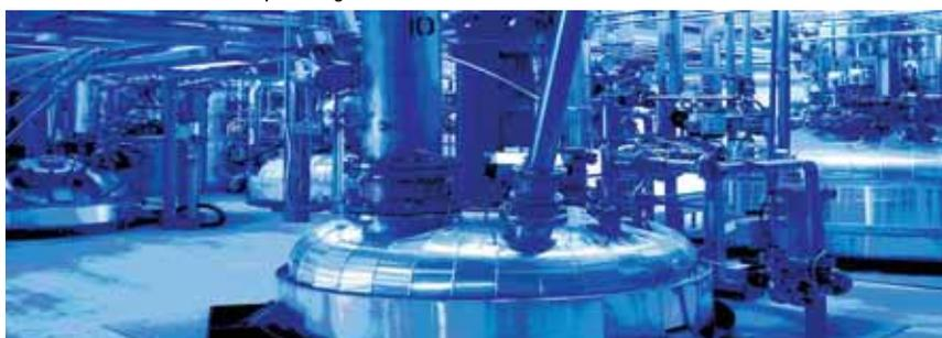
**Produzione resine.** L'impianto di produzione resine della Cavenaghi include 4 reattori completamente computerizzati e 5 parzialmente computerizzati, per una capacità totale installata di 90.000 litri.
