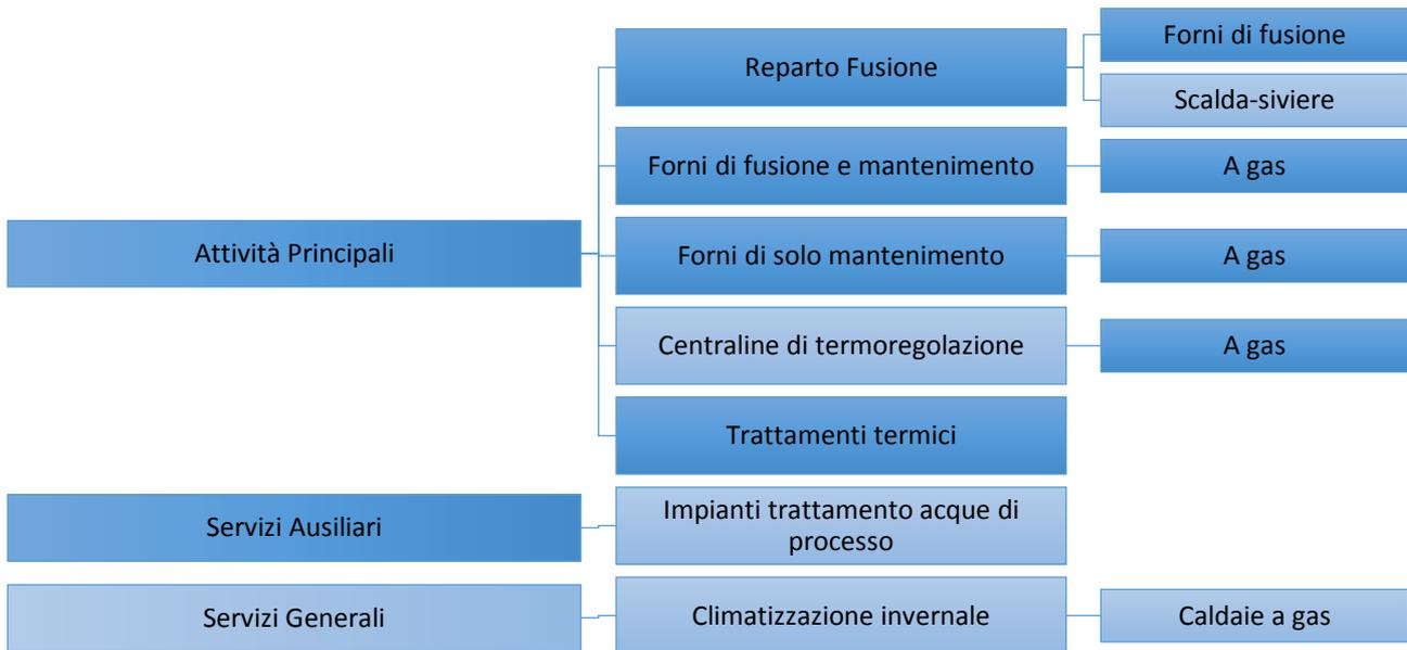
Schema 2 - Schema energetico gas naturale - Usi da sottoporre a monitoraggio (in azzurro più scuro)
