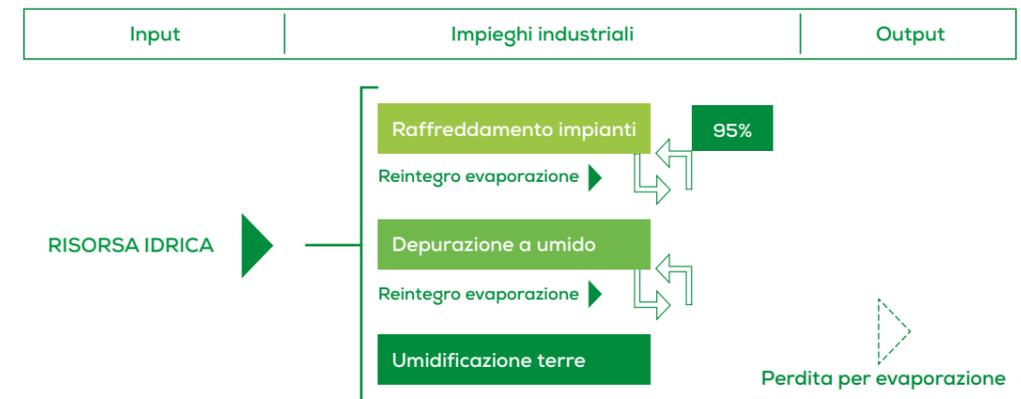
I consumi di risorsa idrica sono limitati alla quota parte utilizzata per l'umidificazione delle terre di formatura (nei processi che utilizzano leganti inorganici argillosi) e per reintegrare l'acqua nei circuiti di raffreddamento degli impianti; in entrambi i casi i consumi sono relativi alla quota parte persa per evaporazione e, come tale, non recuperabile.
