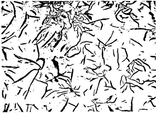
Fig. 109 - Struttura del getto costituita da grafite tipo A5 e B in matrice perlitica.
