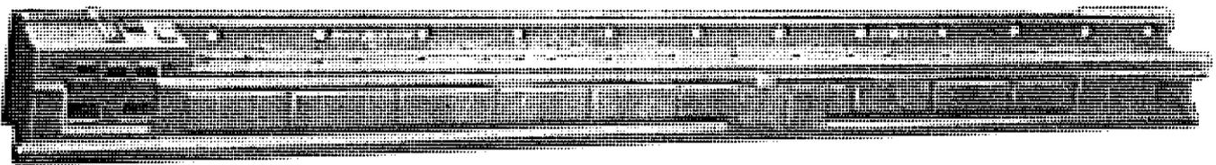
Fig. 357 - Basamento per tornio parallelo. Ghisa G 30 UNI 5007. Peso 7.000 kg.
