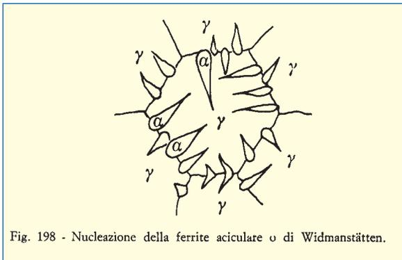
Fig. 198 - Nucleazione della ferrite aciculare o di Widmanstätten.
