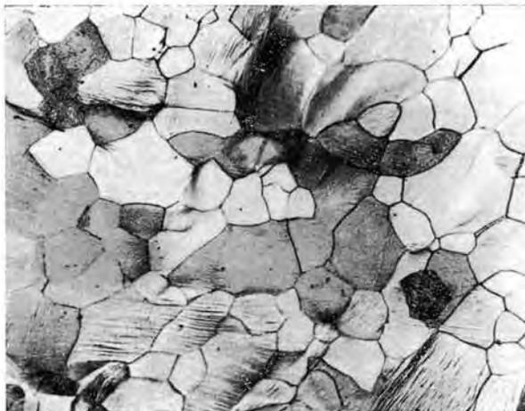
Fig. 13 - Aspetto dei grani di ferrite in un acciaio extra-dolce incrudito.
