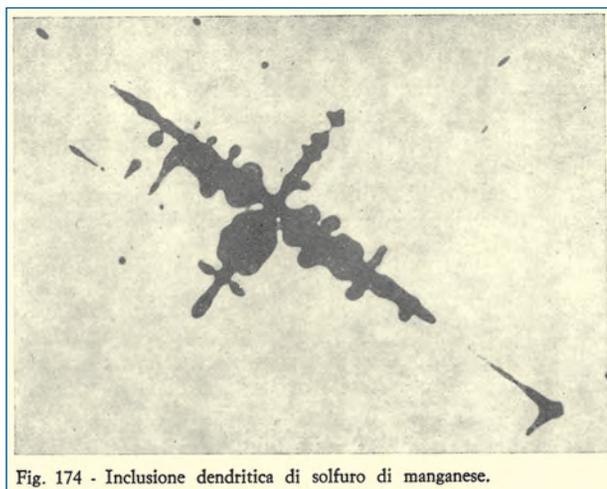
Fig. 174 - Inclusionione dendritica di solfuro di manganese.
