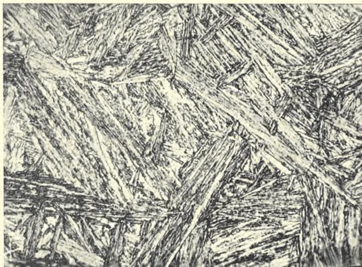
Fig. 212 - Bainite superiore. x 1000
