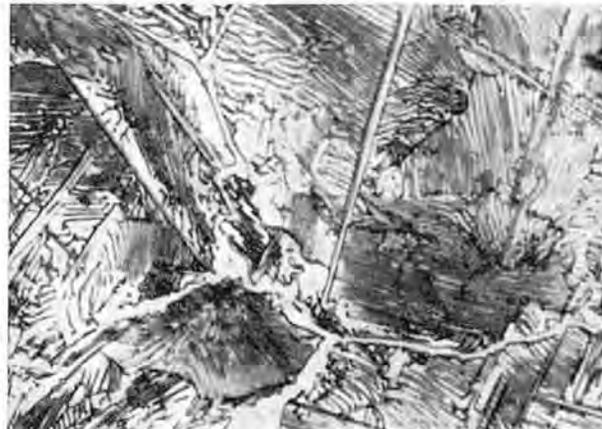
Fig. 49 - Acciaio ipereutettoide costituito da aghi di cementite secondaria e da perlite.
