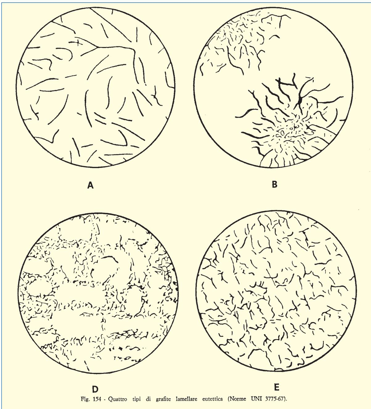
Fig. 154 - Quattro tipi di grafite lamellare eutettica (Norme UNI 3775-67).
